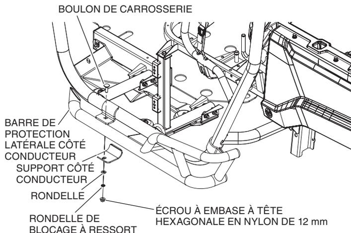
6. Placer et régler le produit pour s'assurer que le support arrière entre en contact avec le tube, puis serrer le boulon à embase à tête hexagonale de 12 mm à la valeur spécifiée dans le TABLEAU DES COUPLES.
