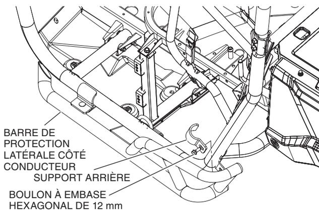
7. Régler et serrer le support du côté conducteur à la valeur spécifiée dans le TABLEAU DES COUPLES.
